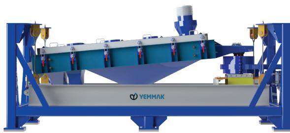
Ürün, besleme noktasında dairesel hareketle başlar, makine boyunca ilerlerken eliptik bir yola dönüşür ve boşaltma ucunda doğrusal hareket kazanır. Dikey hareket bileşeni olmadığından, malzeme sürekli elek yüzeyiyle temas halinde kalır ve etkin bir eleme süreci sağlanır.
